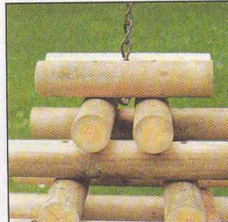
Жерди раскаивают по длине торцовочной пилой. В 10 см от торцов сверлят отверстия под болты. Для подвески «люстры» используют оцинкованную цепь.
