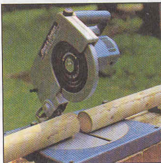
Жерди раскаивают по длине торцовочной пилой. В 10 см от торцов сверлят отверстия под болты. Для подвески «люстры» используют оцинкованную цепь.
