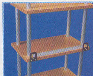
Выравнивая полки, размечают положение фиксирующих их шурупов, и в этих местах в трубках сверлят отверстия Ø3 мм.
