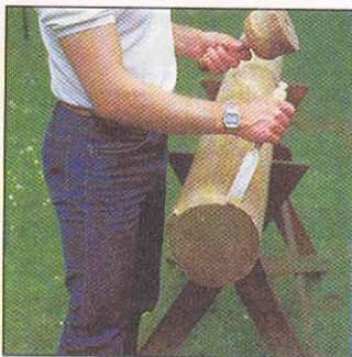
Фаски на торцах бревен обеспечивают быстрый сток дождевой воды. Деревянные детали светильника соединяют шурупами-«глухарями» длиной 14 см. Осветительную арматуру крепят снизу к шайбе.
